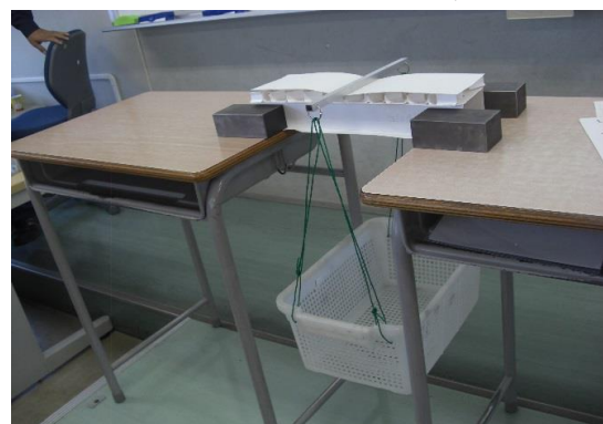
写真3 載荷試験の様子(下)
