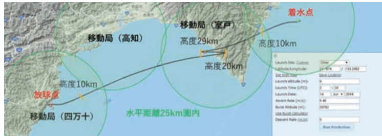
図7 気球の飛行予測と、地上局によるLoRa通信圏の例
