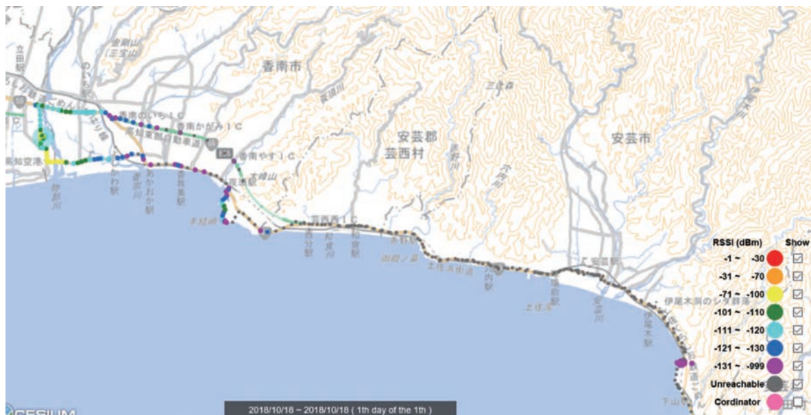
図5 車載実験（2018.10.18、SF=7）での通信位置と受信レベル
