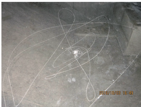
写真21 野書き計による免震層変位応答の軌跡
