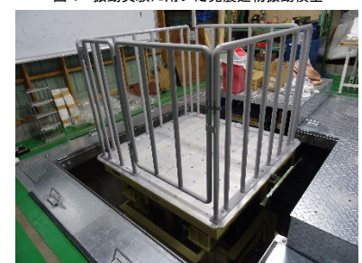
図5 振動実験に用いた免震建物振動模型
