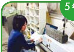
コンクリート内部の劣化状態を超音波を用いて検査する機械です。卒業研究ではこれまでの知識を活かして研究をしています。
