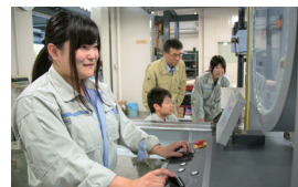
FA コンクリートの圧縮強度試験 FA concrete compressive strength test
