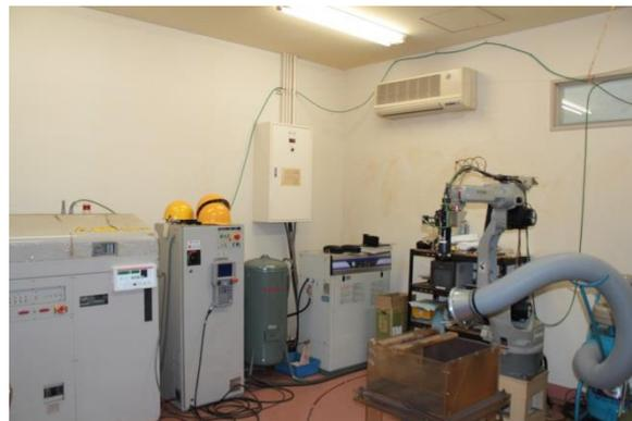
ワイヤ放電加工機 (Wire electric discharge method machine)
