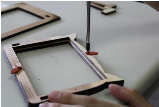
写真 5 ストッパーの取り付け
