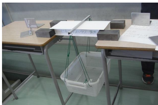
写真2 ペーパーブリッジ载荷試験の様子
