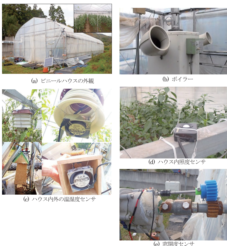
図1 ビニールハウスと各種センサ類の外観
